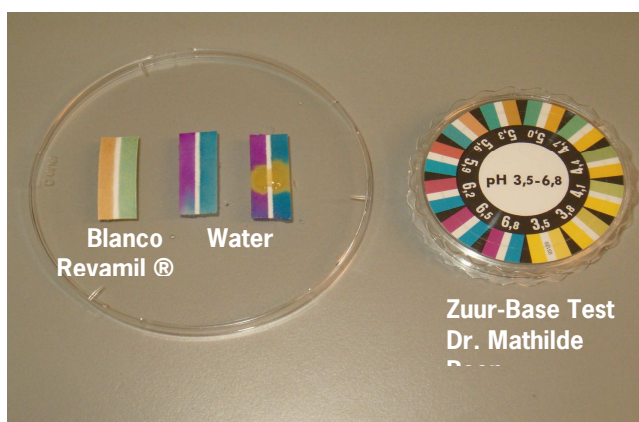
Fig. 2 Zuur-Base Test van Dr. Mathilde Boon. Rechts pH papier met kleurenschaal voor aflezen pH waarde. Links pH papier blanco (linker stripje), pH papier met water (middelste stripje) en pH papier met water en druppel Revamil® Vagicare
